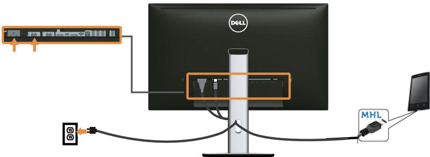
4. Seleccione la fuente entrada en el monitor en **HDMI (MHL) 1** o **HDMI (MHL) 2** mediante el menú OSD (consulte [Utilizar el menú en pantalla \(OSD\)](#) para obtener más detalles).
