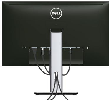
Tras acoplar todos los cables necesarios a su monitor y PC, (vea [Conectar el monitor](#) para el acoplamiento de los cables), organice todos ellos tal y como se muestra anteriormente.
